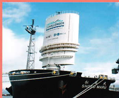
▲1段に畳み込んだ硬翼帆
